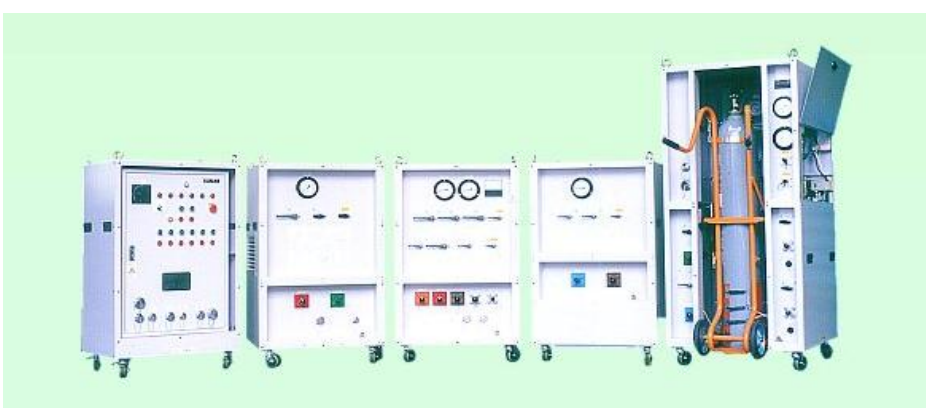
■ SF 6 ガス回収処理装置(分割形) 絶縁ガストランス、開閉機器の絶縁媒体を代表とするSF 6 ガスの処理装置です。現場でSF 6 ガス封入機器より回収、貯蔵しながら精製し、機器に再充填します。回収方式には気体回収と液化回収があります。
