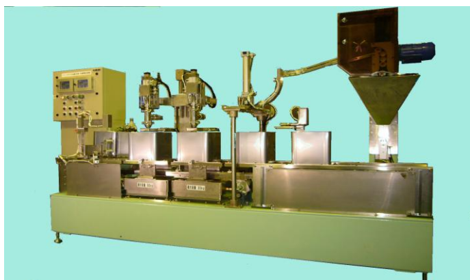
■ 自動充填・封緘装置 (18L角缶・ハーフ缶兼用)
