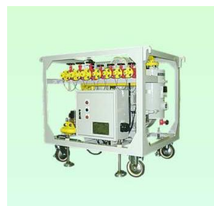
■ SF6ガス用真空排気装置 ガス開閉装置等の新設やメンテナンス作業時に使用します。真空排気とガス充填の両方機能を持ち、各々3回路同時に使用できます。
