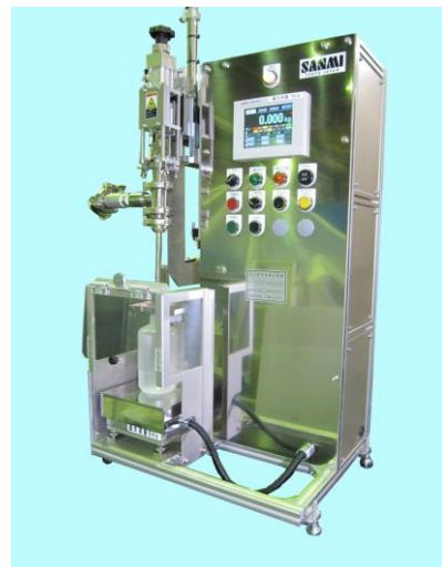
■ 小缶用半自動充填機 (1L角/丸容器、 0.3L角容器兼用)
