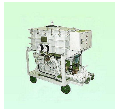
■ 密閉式油濾過機(SF型) フィルターによるコンタミ除去、アルソ(活性アルミナ)による油中水分の吸着で、油の耐電圧を上昇させます。能力：25ℓ～165ℓ/min
