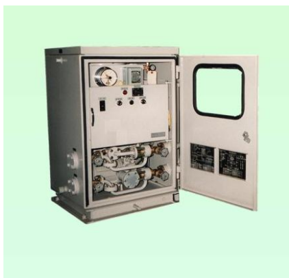
■ “ALSO”式活線浄油機 変圧器・タップ切換室の絶縁油に生成される有機酸や水分を吸着、またカーボン・コロイド金属粒子等の不純物を除去します。
