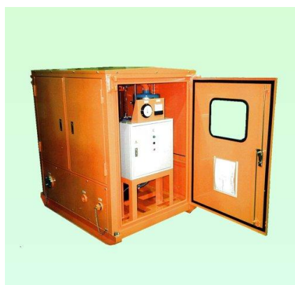
■ 真空排気装置 変圧器の真空排気とタンク内の除湿を行います。
