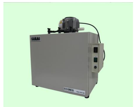
■ SC型ブリーザ再生装置 SC型環境調和ブリーザを再生する専用装置です。1kg×2個／8～10hで再生。
