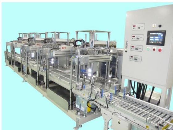
■ 缶内調色 自動ジャロミキサーライン (4L丸缶、18L角缶)
