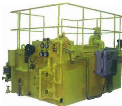
■ タービン油清浄機(パウザー式) 火力・原子力発電所の蒸気タービンに使用される潤滑油の特性を保持する為、常時循環しながら油を清浄する装置です。能力：1,000ℓ～18,000ℓ/h
